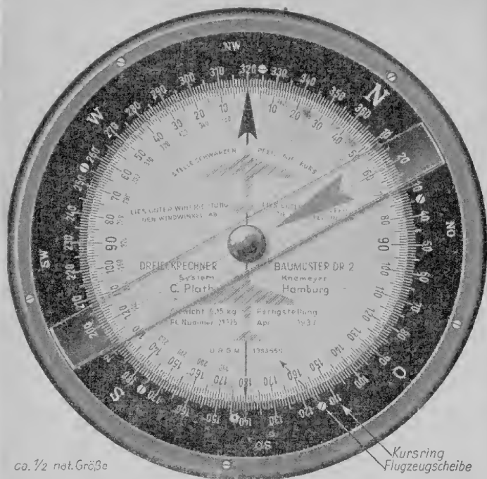
Dreieckrechner Plath DR 2, Vorderseite
