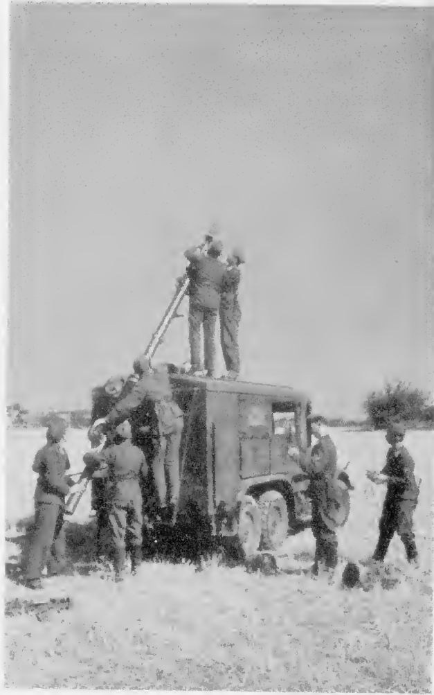
Der Antennenmast wird vom Lastwagendach getrennt und aufgerichtet
