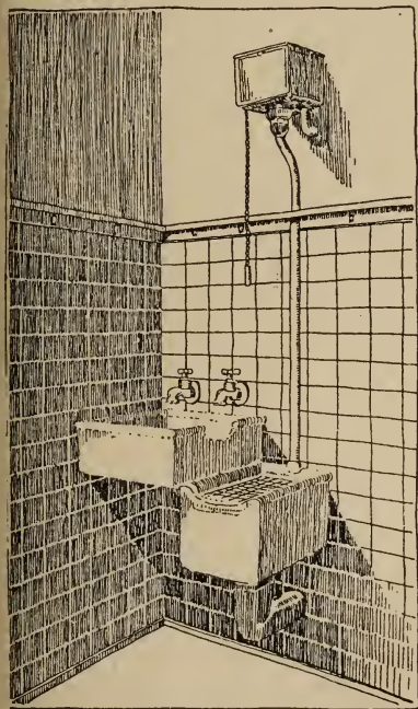
Abb. 206. Schmutzausguß und Wasserzapfstelle im Reinmacheraum
